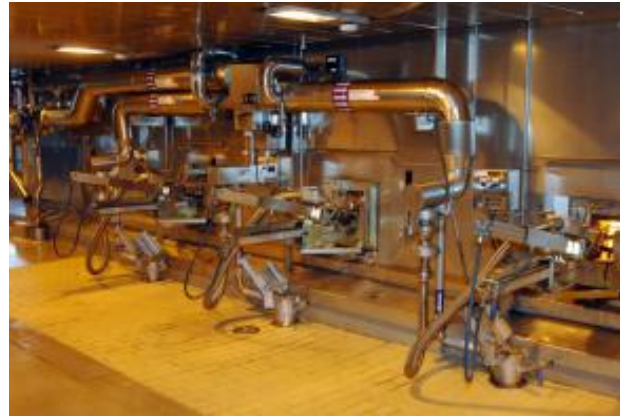
Sort lud - et restprodukt fra produktionen af papir fødes ind i den ny genvindingskedel. Kedlen genvinder kemikalier, og laver damp som bruges til tørrecylindre og kartonproduktion.
